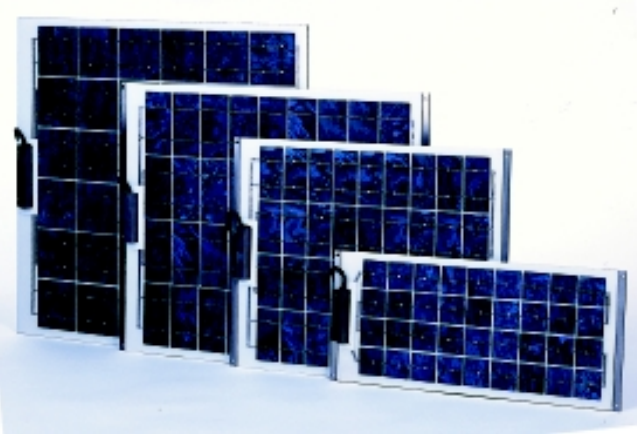
Les modules NP12RSS (12 Watts), NP24RSS (24 Watts), NP35RSS (35 Watts) et NP50RSS (50 Watts) comprennent 36 cellules polycristallines en série, configuration optimale pour la charge de batteries 12V.
