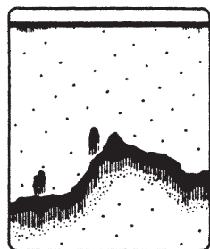
Interférences générées par un autre sondeur
